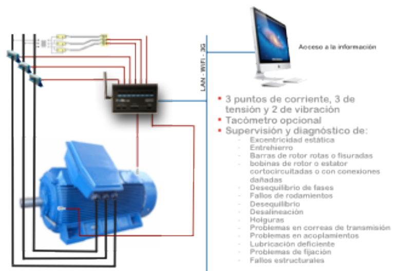
Figura 6: Ejemplo de monitorización de motores eléctricos iMotor™
