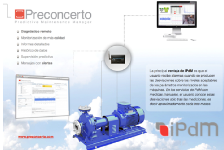
Figura 9: Estructura básica sistema iPdM™
