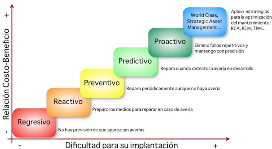
Fig. 1. Clasificación de las estrategias de mantenimiento en función de su relación costo-beneficio y de la dificultad para su implantación.
