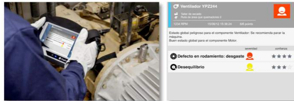
Fig. 3. Colector de vibraciones con diagnóstico automático FALCON de ACOEM.
